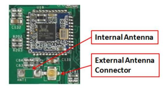
Figure 1044: RTL8273 WiFi/BT Module
